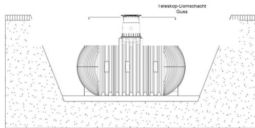
Überdeckungshöhen mit Zwischenstück und Teleskop Domschacht maximal 1500 mm.
