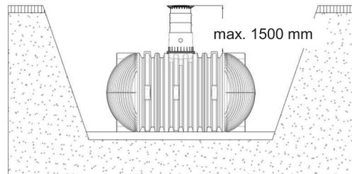
Überdeckungshöhen mit Teleskop Domschacht Guss (mit Gussabdeckung Klasse B) im PKW befahrenen Bereich (Belastung bis 3,5 t).
