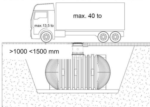
Die Tanks dürfen nur bedingt ins Grundwasser eingebaut werden. Ist zu erwarten, dass Grundwasser auch nur gelegentlich höher ansteigt, als in der nebenstehenden Abbildung gezeigt, ist dieses durch eine Drainage abzuleiten.
