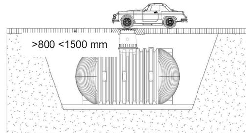
Überdeckungshöhen mit Teleskop Domschacht LKW (Abdeckung Klasse D – bauseits zu stellen) im LKW befahrenen Bereich (Belastung bis 40 t).
