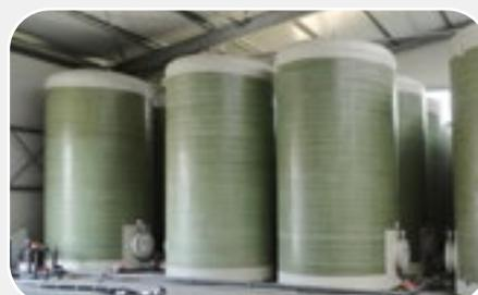
Lagerbehälter aus GFK für verschiedene Flüssigkeiten
