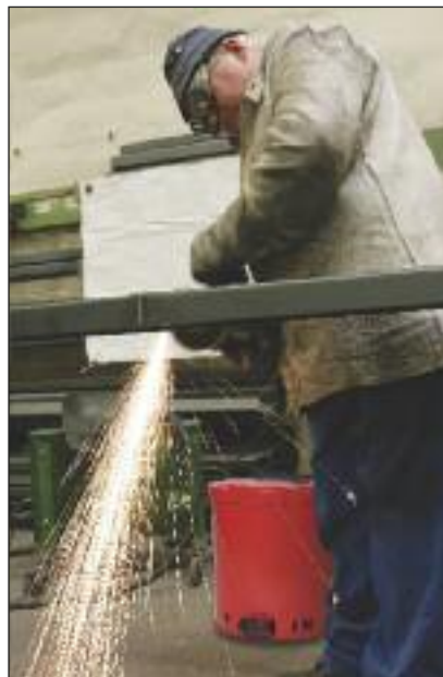
Sicherheit am Arbeitsplatz: generell selbstschließender Deckel verhindert eine Entzündung des Inhalts z.B. durch Funkenflug
