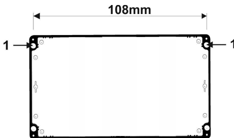
Abbildung 5: Lage der Befestigungsbohrungen (Innenansicht ohne Deckel)
